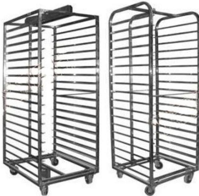
Для ориентации в различных ротационных печах тележки имеют нижний узел посадки на шар, верхнее устройство подвеса за крюк, или вращаются на платформе.
